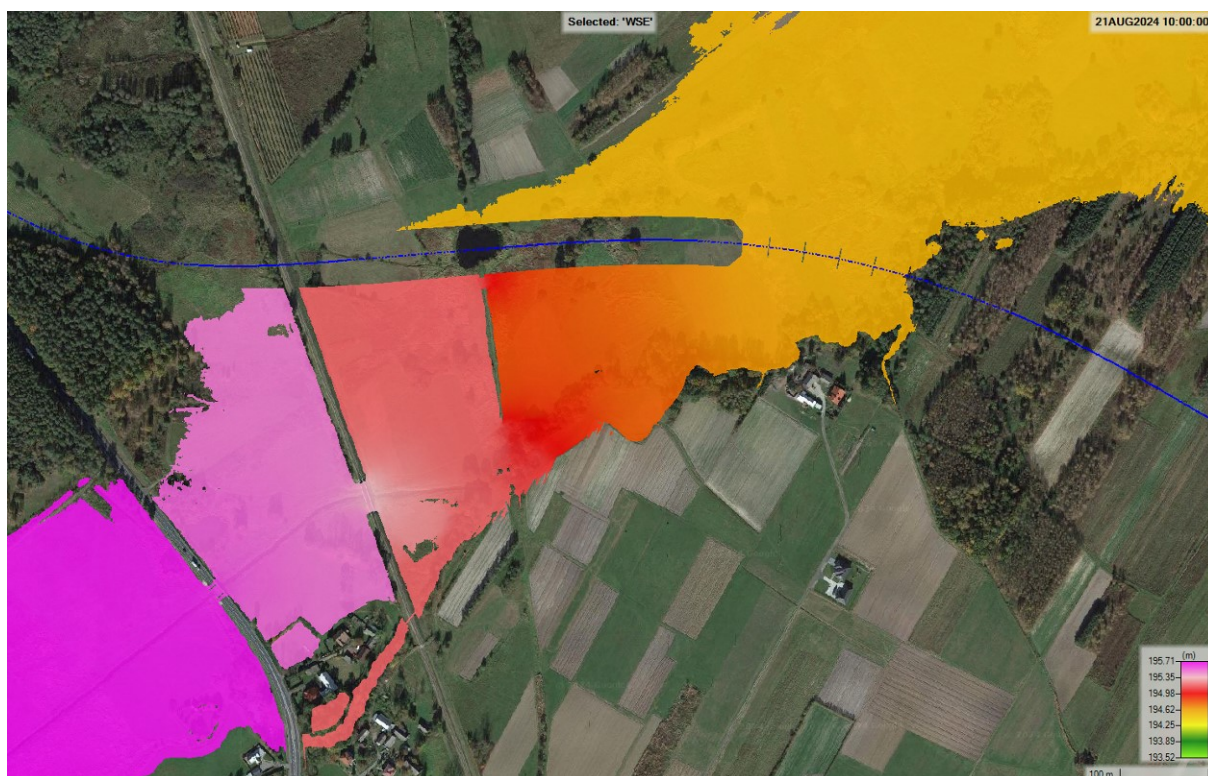
Rysunek 15 Rzędna zwierciadła wody w stanie zabudowanym – Wariant 4.1A - Q_{0.5\%} - „z zaporą”
