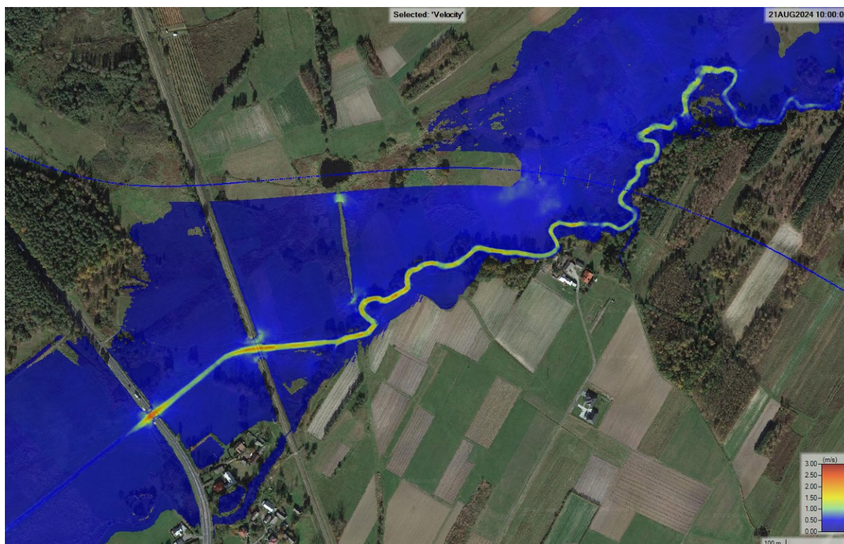
Rysunek 16 Prędkość wody w stanie zabudowanym – Wariant 4.1A - Q_{0,5\%} - „bez zapory”
