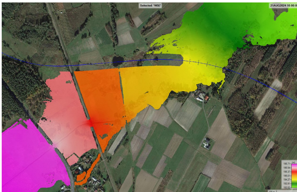
Rysunek 14 Rzędna zwierciadła wody w stanie zabudowanym – Wariant 4.1A - Q_{0.5\%} - „bez zaporę”
