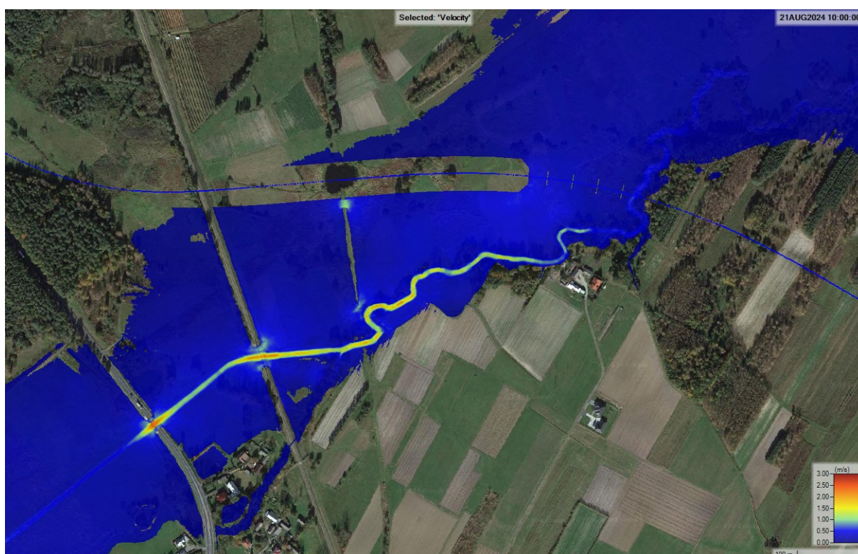
Rysunek 17 Prędkość wody w stanie zabudowanym – Wariant 4.1A - Q_{0,5\%} - „z zaporą”
