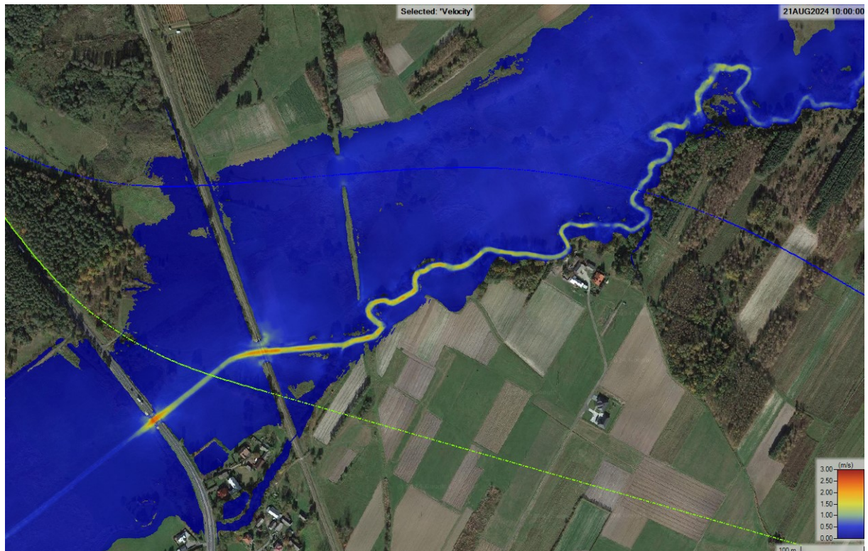
Rysunek 10 Prędkość wody w stanie niezabudowanym Q_{0,5\%} - „bez zapory”
